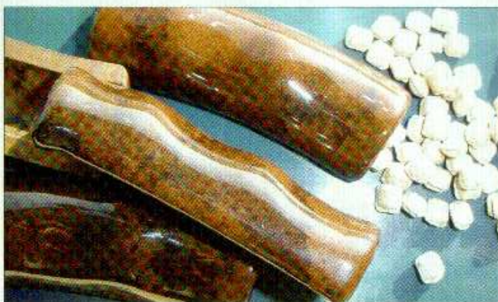
Formsache: Das verflüssigte, größtenteils auf zerkleinerten Naturfasern basierende Granulat lässt sich in beliebige Formen gießen.
